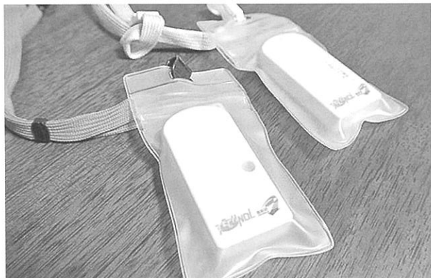
積算線量計の1つ。時間ごとの被曝量を計算してくれるため、日常生活のどの部分で被曝が起きているか分かる
